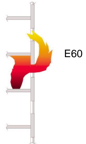
Brandweerstand van het gevelement
